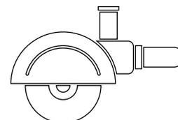
Tronçonneuse portative avec moteur thermique
